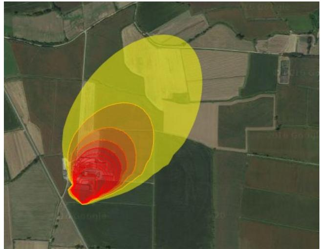
*Curve di isolivello delle ricadute di odore*
